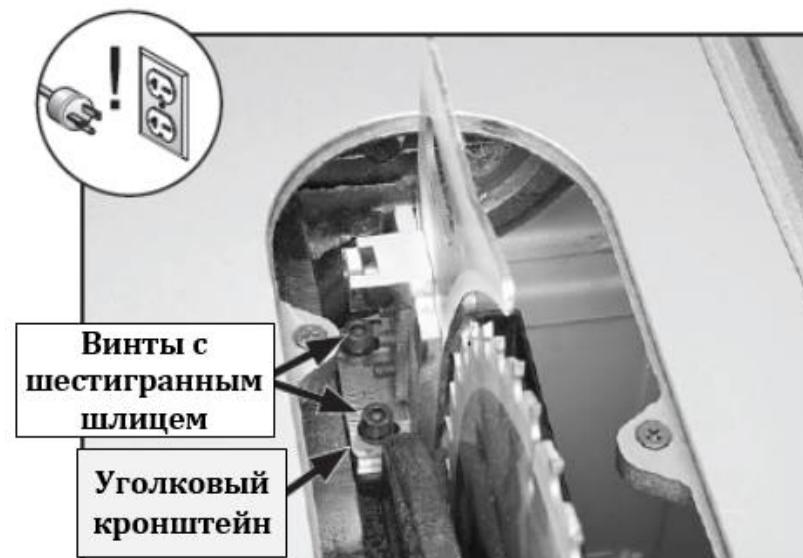
Рис. 45. Винты с шестигранным шлицем для регулировки положения распорки или расклинивающего ножа
