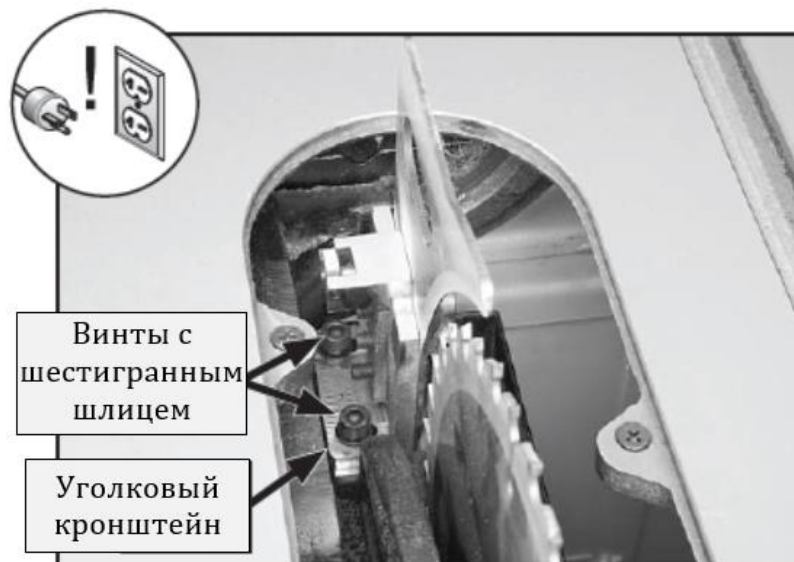
Рис. 37. Винты с шестигранным шлицем для регулировки положения распорки или расклинивающего ножа
