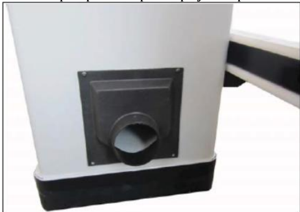
Рис. 17. Крепление штуцера аспирации опилок
