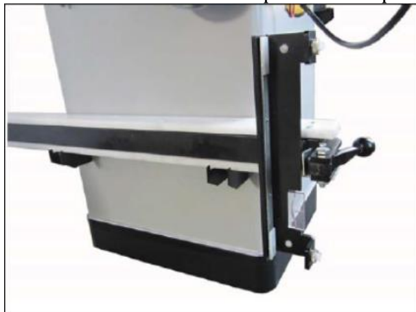
Рис. 15. Крепление двух кронштейнов подручника
