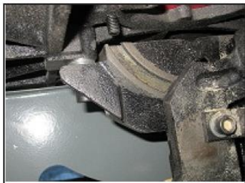
Рис. 24. Направляющие качающихся опор и червяк наклона
