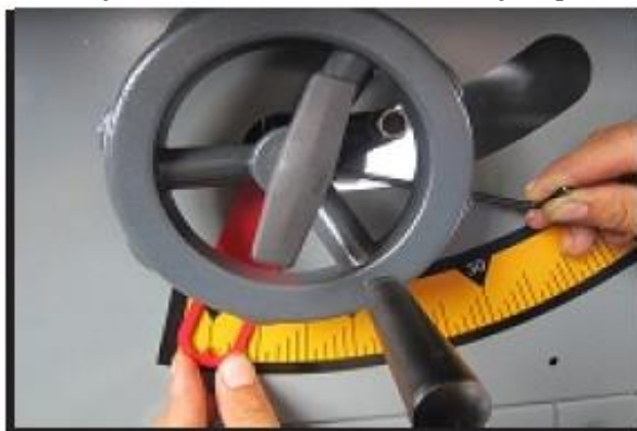
Рис. 28. Установка указателя на 0^\circ
