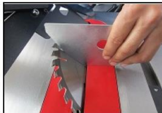
Рис. 29. Наклон дисковой пилы на угол 45^\circ
