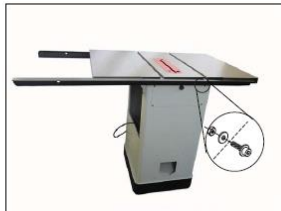
Рис. 10. Установленная на станке задняя направляющая
