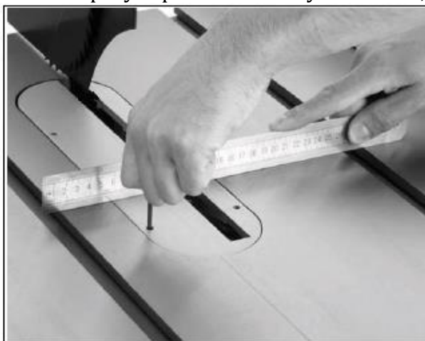
Рис. 23. Регулировка вставки стола по высоте
