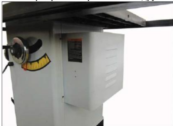
Рис. 13. Крепление крышки двигателя
