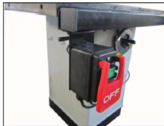
Рис. 12. Закреплённый на направляющей выключатель
