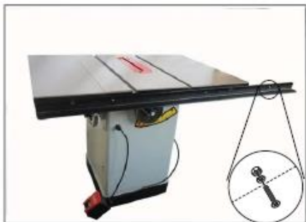
Рис. 9. Установленная на станке передняя направляющая
