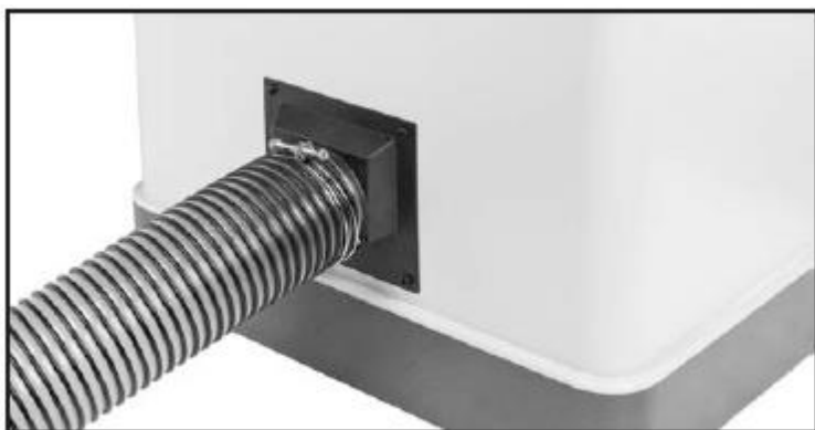
Рис. 22. Шланг для отсоса опилок, подсоединённый к патрубку отсоса опилок
