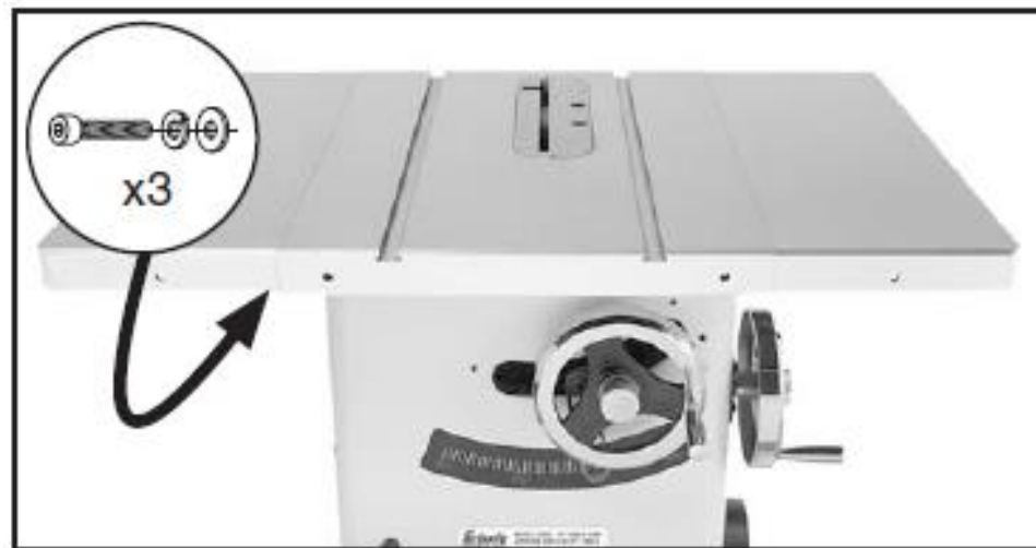
Рис. 12. Установленные расширительные консоли
