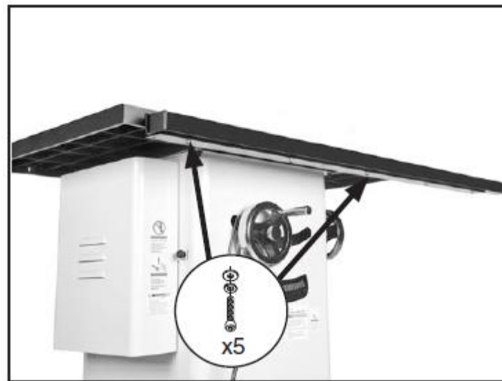
Рис. 16. Прямоугольная труба, закреплённая на передней направляющей
