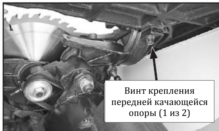
Рис. 71. Винт крепления передней качающейся опоры
