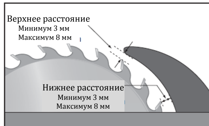
Рис. 41. Допускаемые верхнее и нижнее расстояния между расклинивающим ножом и диском пилы
