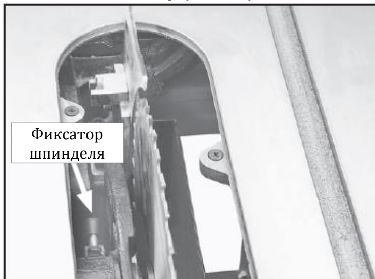
Рис. 32. Расположение фиксатора шпинделя
