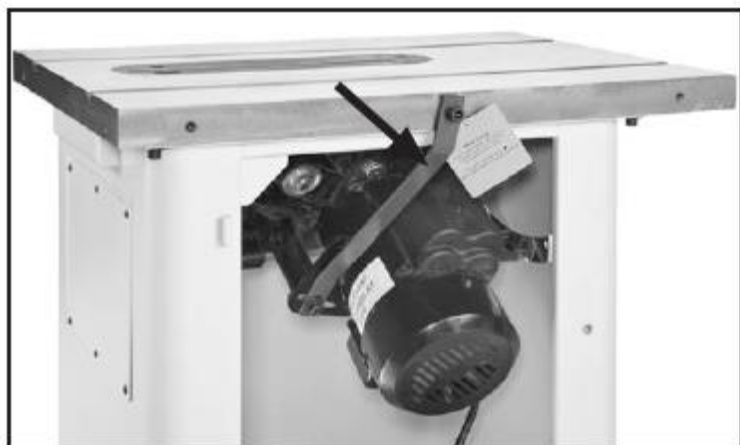
Рис. 9. Расположение транспортных креплений
