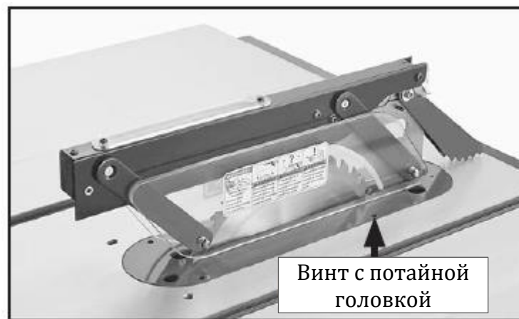
Рис. 36. Установленное ограждение пилы
