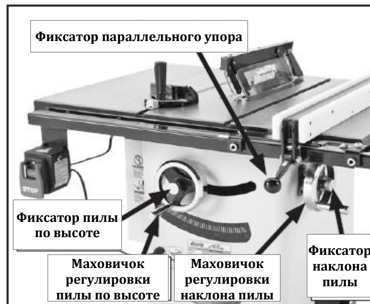
Рис. 24. Органы управления циркулярной пилой
