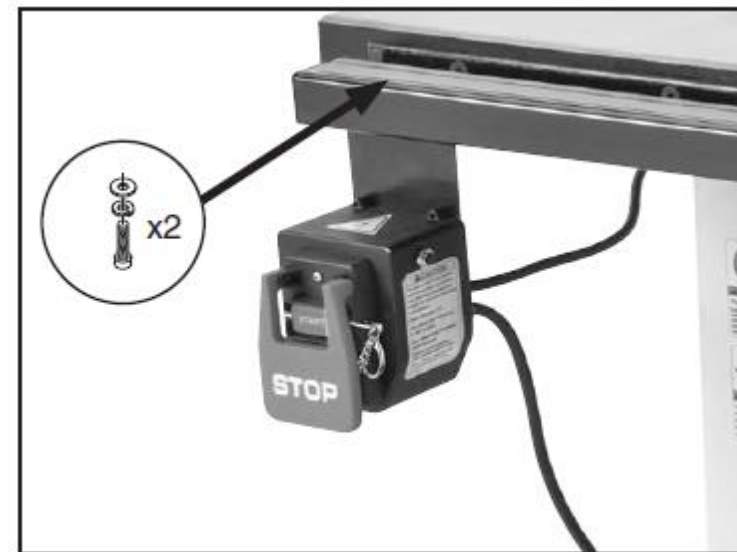
Рис. 21. Установленный магнитный пускатель
