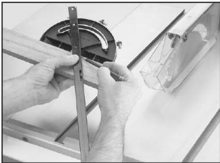
Рис. 44. Пример разметки линии реза под углом
