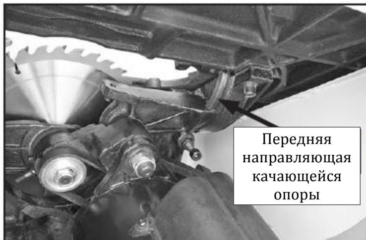
Рис. 59. Направляющая качающейся опоры (показана только передняя направляющая)
