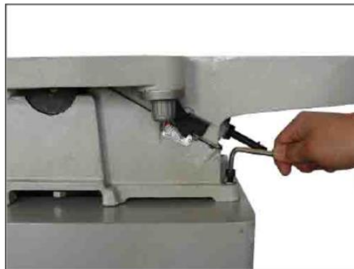
Рис. 4. Установка переднего крепёжного болта
