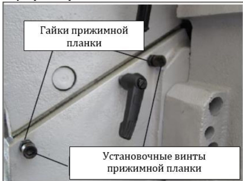
Рис. 30. Органы регулировки прижимных планок выводного стола
