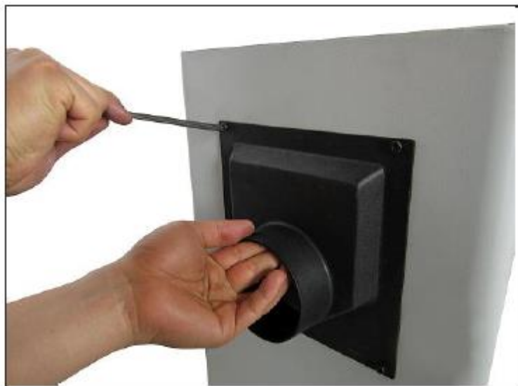
Рис. 14. Установка патрубка аспирации опилок
