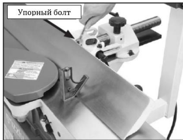
Рис. 29. Контргайка упора под угол 45° положения параллельного упора
