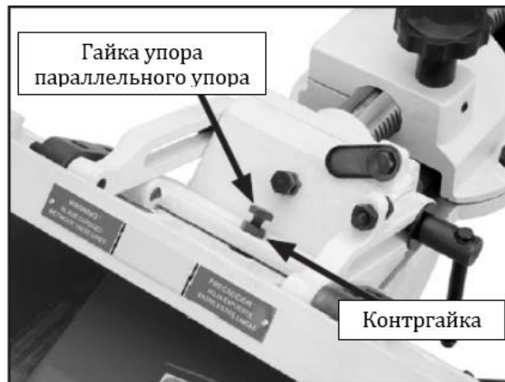
Рис. 25. Контргайка упора под 45°
