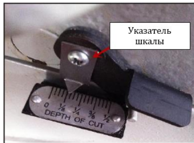
Рис. 23. Указатель шкалы глубины резания, настроенный на нулевое положение
