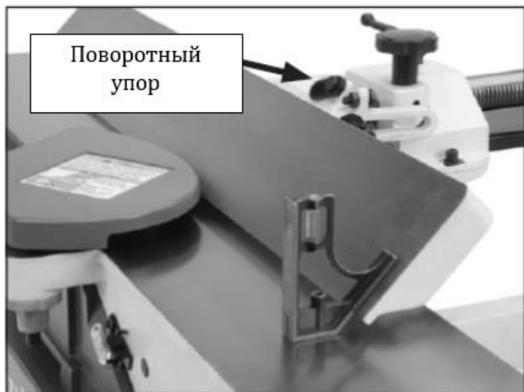
Рис. 28. Регулировка параллельного упора под углом 45° наружу
