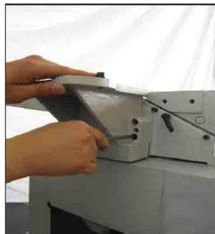
Рис. 9. Собранный кронштейн крепления каретки
