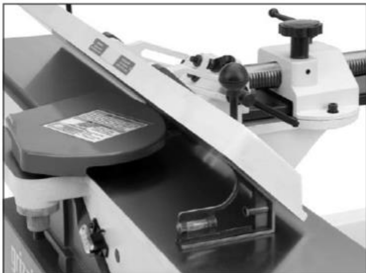
Рис. 24. Настройка под угол 45° внутрь
