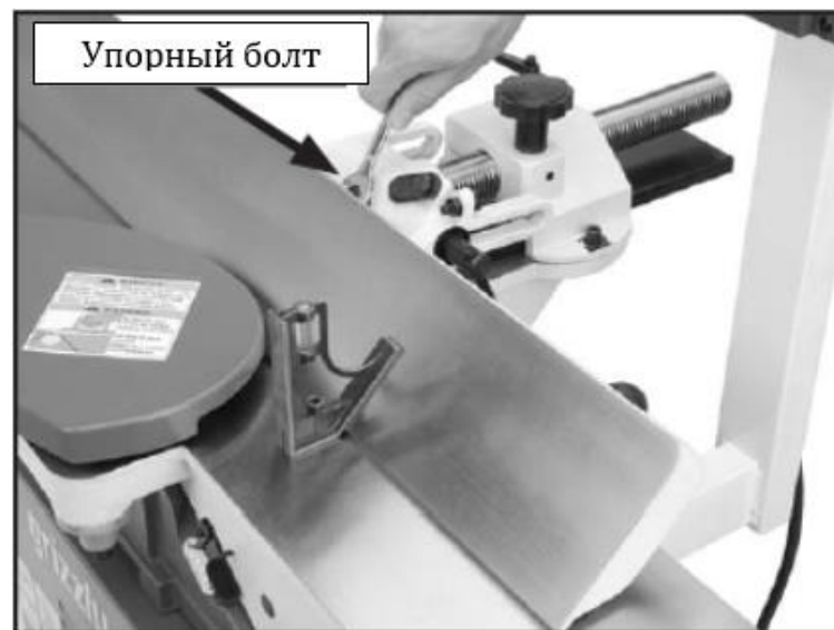
Рис. 29. Контргайка упора под углом 45° положения параллельного упора
