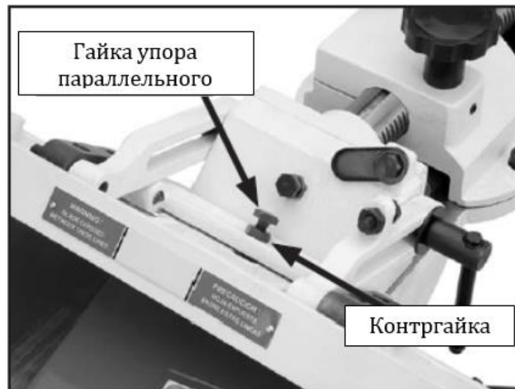
Рис. 25. Контргайка упора под 45°
