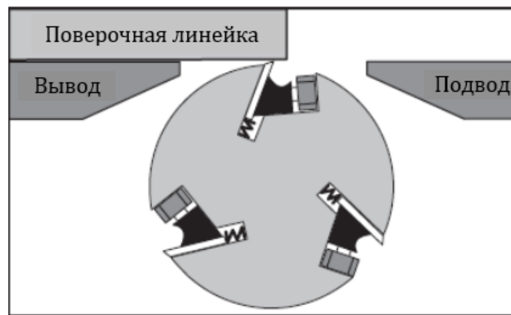
Рис. 18. Использование поверочной линейки для выравнивания выводного стола по высоте с ножом в ВМТ
