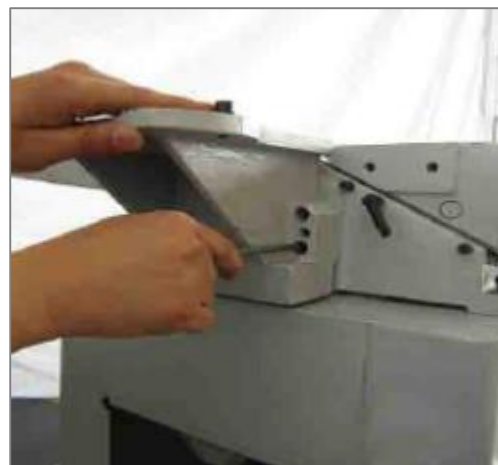
Рис. 9. Собранный кронштейн крепления каретки
