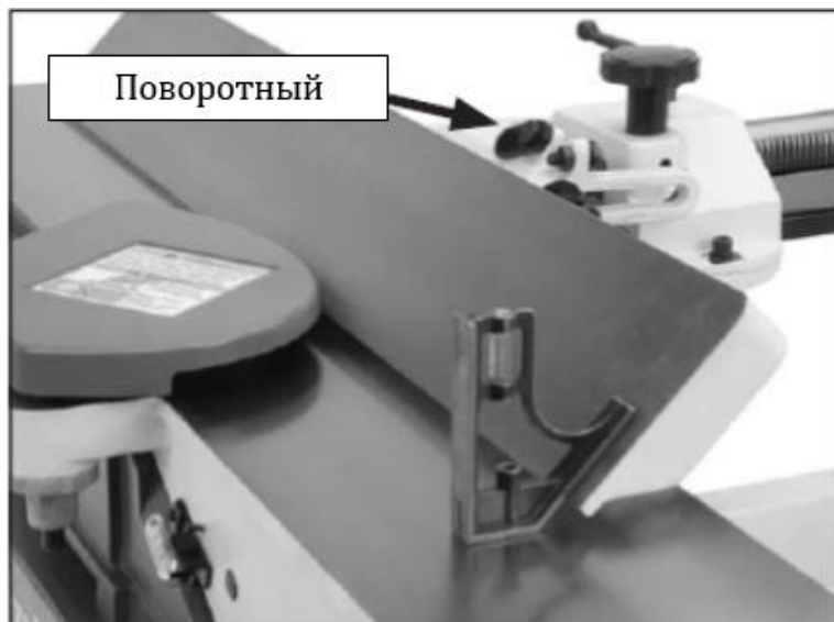
Рис. 28. Регулировка параллельного упора под углом 45° наружу
