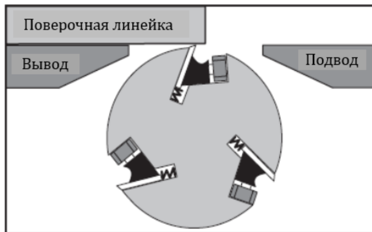
Рис. 22. Подводной стол, отрегулированный вровень с выводным столом и ножом в ВМТ
