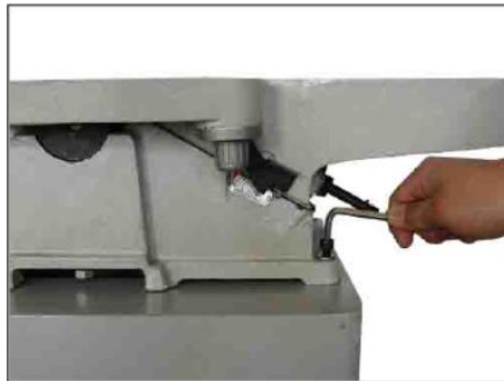
Рис. 4. Установка переднего крепёжного болта
