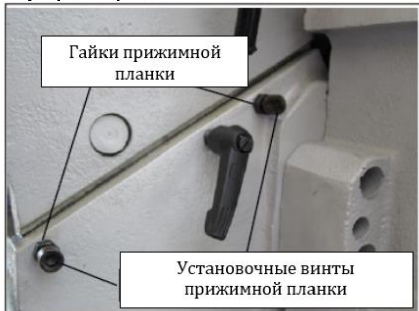
Рис. 30. Органы регулировки прижимных планок выводного стола
