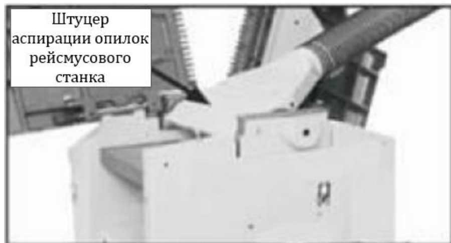
Рис. 23. Наладка штуцера аспирации опилок рейсмусового станка
