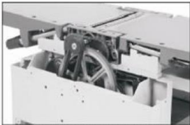
Рис. 46. Снятые параллельный упор и крышка клиноремённой передачи
