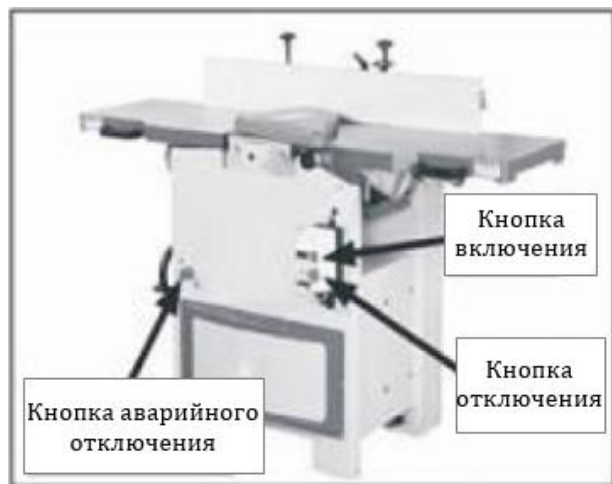
Рис. 15. Расположение кнопок включения-отключения
