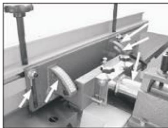
Рис. 30. Точки смазки параллельного упора
