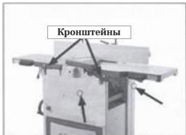
Рис. 6. Расположение передних и задних такелажных отверстий
