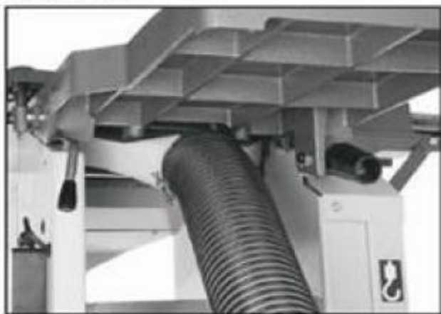
Рис. 12. Рукав аспирации опилок, закреплённый на фуговальном станке
