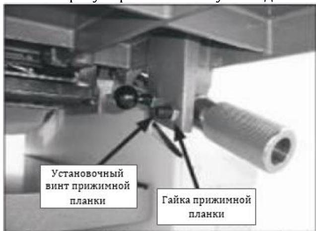
Рис. 52. Регулировка прижимной планки подводного стола
