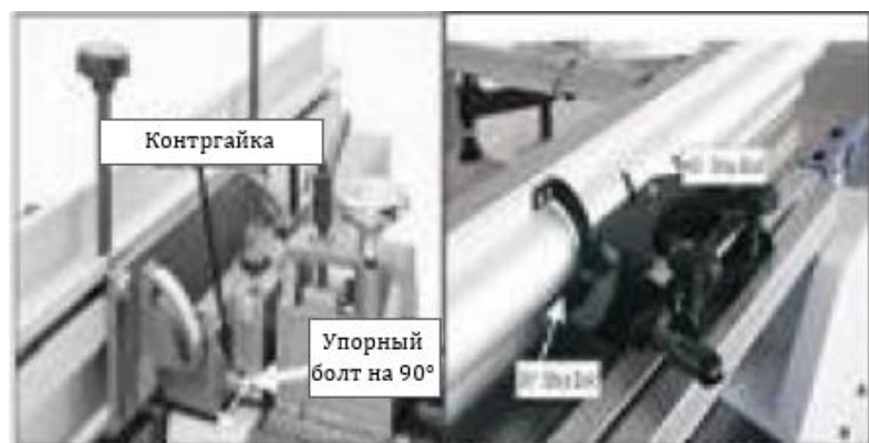
Рис. 49. Регулировка параллельного упор на 90^\circ
