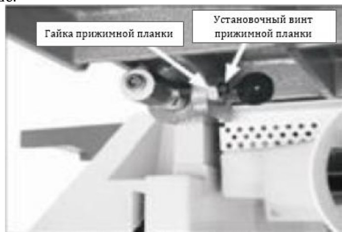
Рис. 53. Регулировка прижимной планки выводного стола
