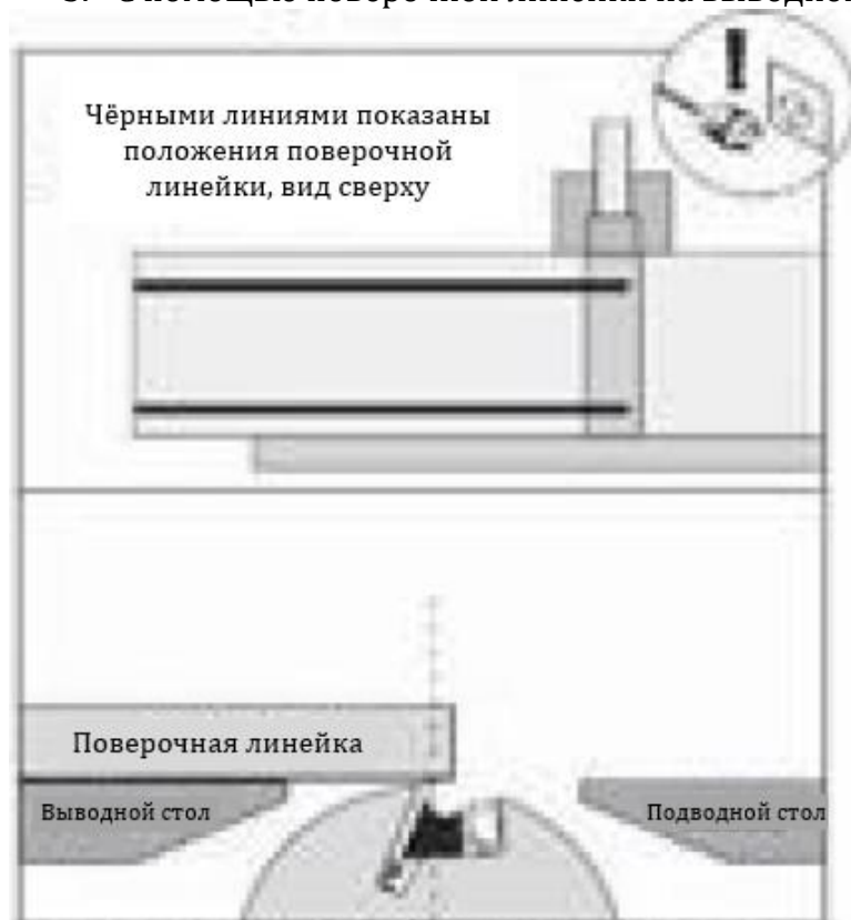
Рис. 38. Проверка высоты ножа поверочной линейкой
