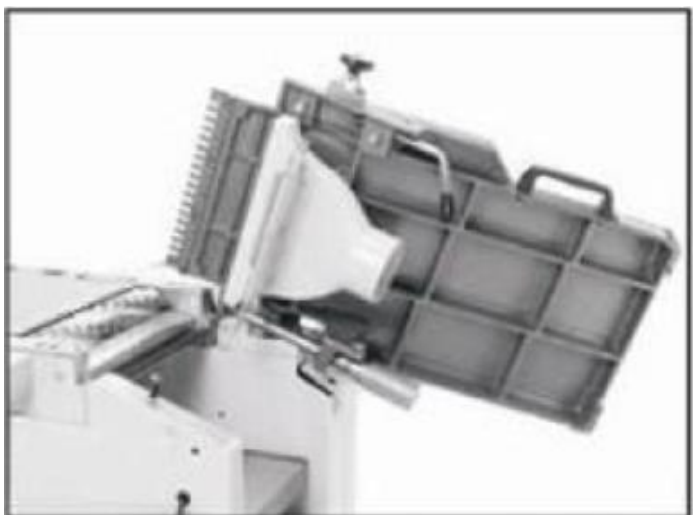
Рис. 22. Подводной стол в верхнем положении
