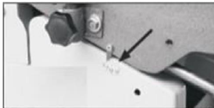
Рис. 45. Шкала глубины резания, установленная в нулевое положение
