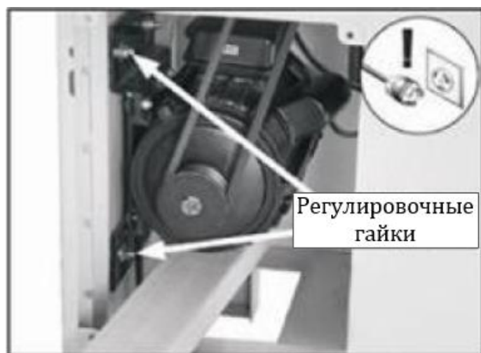
Рис. 26. Снятие натяжения клиновых ремней
