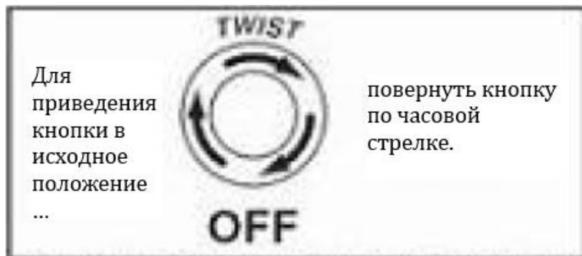
Рис. 14. Приведение кнопки аварийного отключения в исходное положение
