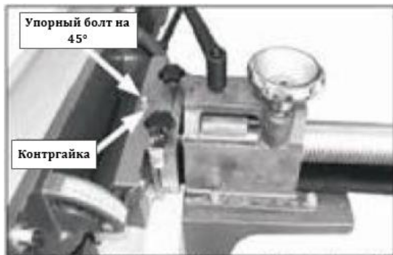
Рис. 50. Регулировка параллельного упора под 45° наружу
