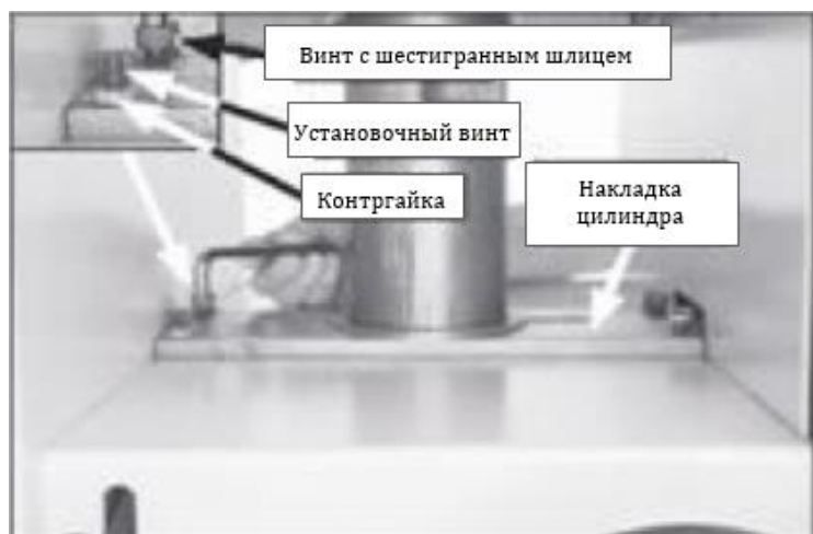
Рис. 56. Регулировка параллельности стола
