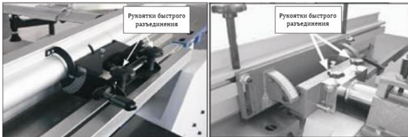
Рис. 20. Снятие параллельного упора
