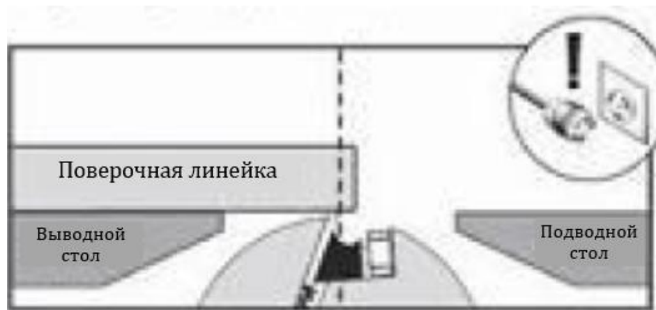
Рис. 9. Использование поверочной линейки для выравнивания выводного стола
