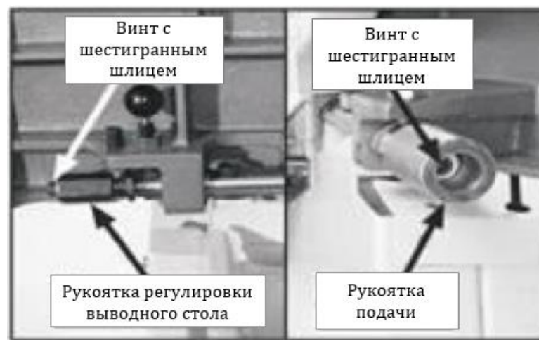
Рис. 16. Расположение органов регулирования столов
