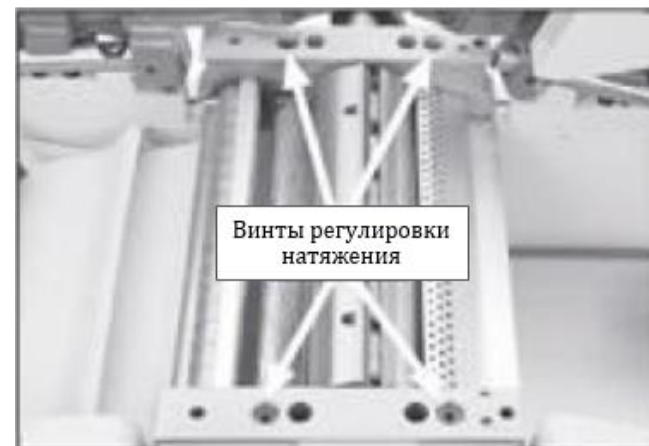
Рис. 57. Винты регулировки натяжения пружины
