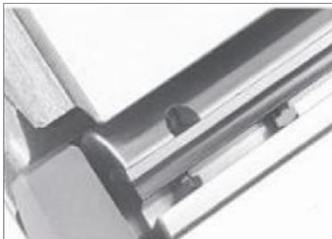
Рис. 41. Отверстия для доступа к прижимным винтам
