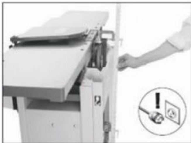
Рис. 47. Проверка выравнивания шкивов
