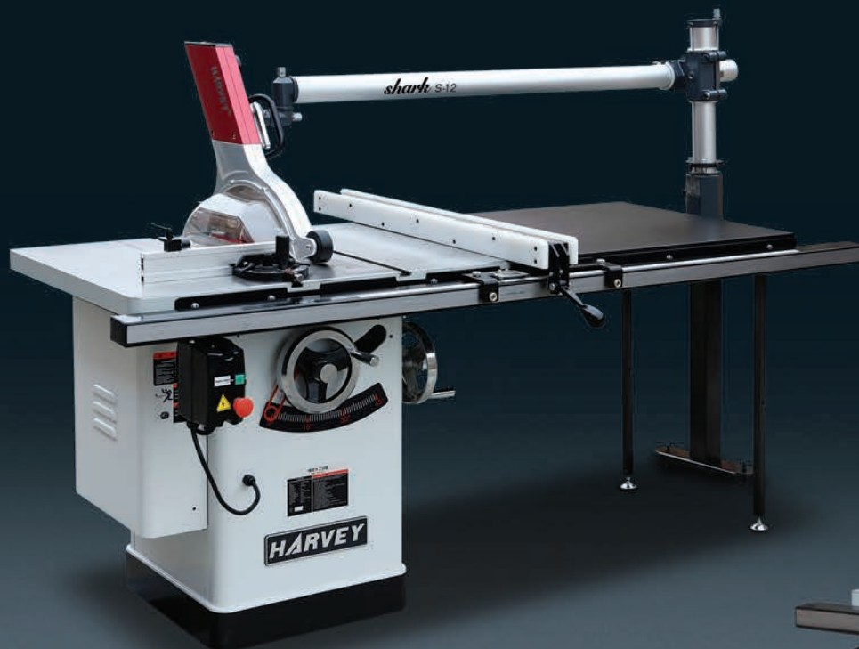
HW110LG-50 с подвесной системой защиты и пылеудаления Shark S-12
